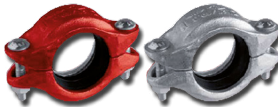
Acoplamiento flexible normal Admite el movimiento controlado lineal y angular, que acomoda la deflexión de la tubería y la expansión y contracción térmica
